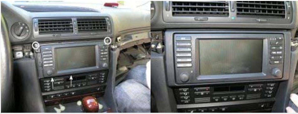
Bilderna visar montering av bildskärmen. Klicka för förstoring.
