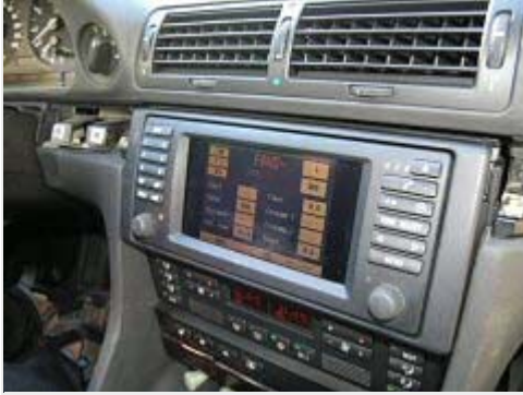
Ser det ut så här är det kanske läge att byta TV-modul. Klicka för förstoring.
