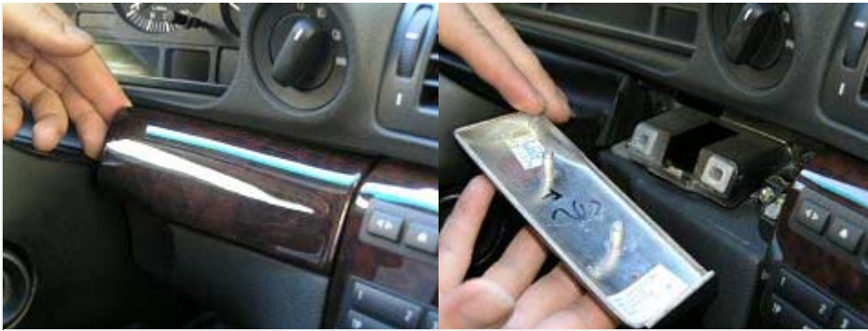
Bilderna visar demontering av gummi- och trälisterna runt mittkonsollen. Klicka för förstoring.
