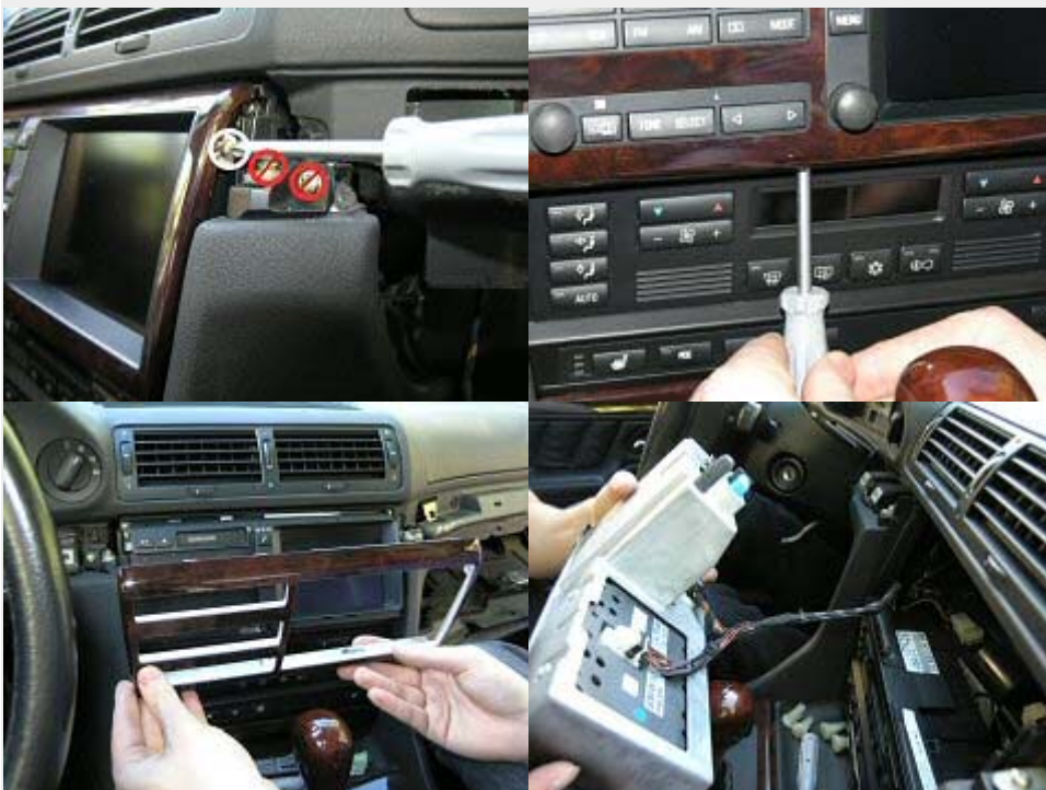
Bilderna visar demontering av bildskärmen. Klicka för förstoring.
